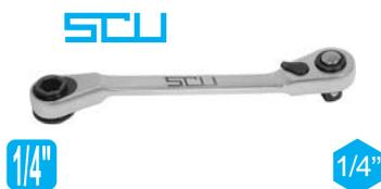
In acciaio CROMO-VANADIO. Leva a cricco COMBINATA, REVERSIBILE, A DOPPIA TESTA con attacco esagonale femmina 1/4" per bits con levetta per movimento D+S da una parte e attacco quadro maschio 1/4" per bussole con levetta per movimento D+S dall'altra. Lunghezza totale mm 115.
